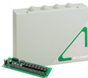
Unità remota con 8 ingressi per sensori 4÷20mA, collegabile solo alla centrale art. 47CPG424 tramite le porte RS485 (max. 2 unità). Alimentazione 230Vca.
